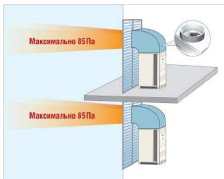
Испытания в аэродинамической трубе позволили спроектировать максимально эффективный вентилятор для блоков серии SMS - K с напором до 85 Па, что обеспечивает возможность установки блоков на технических этажах зданий и отвод горячего воздуха посредством воздуховода.
