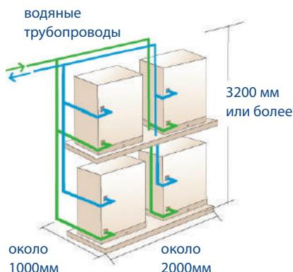
Модули одинакового размера позволяют аккуратно и компактно разместить систему. С помощью комбинаций блоков можно выбрать наиболее подходящую систему в зависимости от потребностей внутренних блоков.
