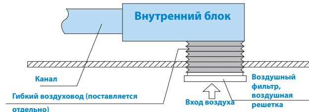
**Примечание:** при организации забора воздуха снизу, уровень шума может повыситься в зависимости от способа монтажа и параметров помещения.
